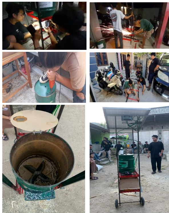
Gambar 2. Pembuatan mesin pencacah portabel tenaga surya
